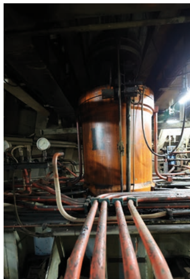
Hydraulika obstarávala velkou část pohybů stroje, proto mělo RK 5000 i vlastní specializovanou profesi hydraulikáře.
